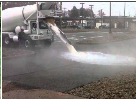
Porézní beton, který je schopný pojmout až 600 l vody za minutu (zdroj: www.ekobydleni.eu )
