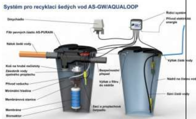
Schéma principu zařízení pro čištění a recyklaci šedé vody (zdroj: www.asio.cz )
